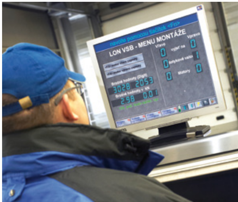
Kalibrovanie prístroja na meranie účinnosti automobilových brzd
