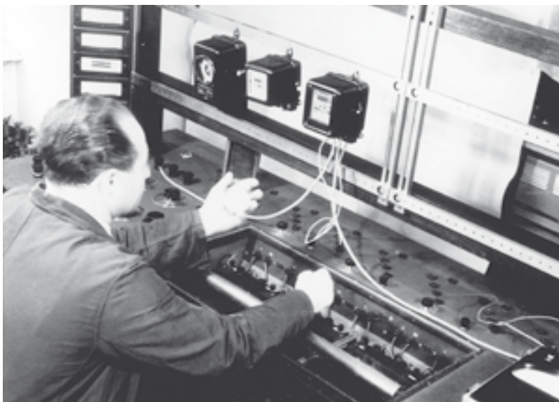
Stanica na skúšanie elektromerov
